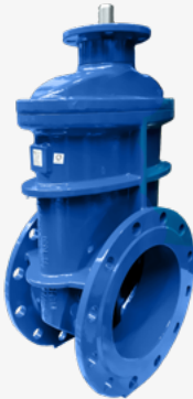
art. 735/740 GAVE EA DN50–600, saracinesca a tenuta morbida con flangia ISO per attuttore elettrico
